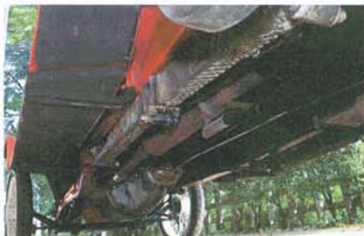
左後輪を外して下から覗く、長いカンチレバー・スプリングとトルクチューブ・ドライブの構造がよくわかる。
