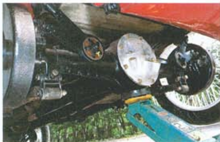
頑丈そうなリアアクスルと左右のフリクション・ディスク式ダンパー。
