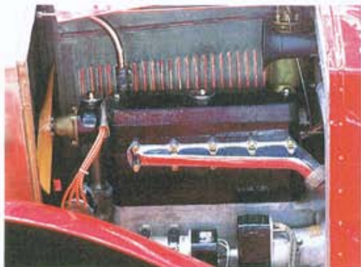
排気側はいっそうすっきり見える。ヘッドとブロック、ブロックとクランクケース間にガスケットはない。全金属で搦めてオイルも水も漏れないのは手仕上げの質の高さを示す。冷却ファンは木製。
