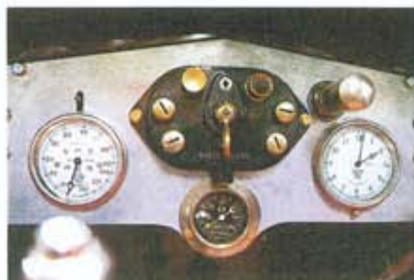
ロバート・ボッシュ製スイッチボードは70年使ってもまだ正確に機能する。速度計と時計は英国のスミス製。
